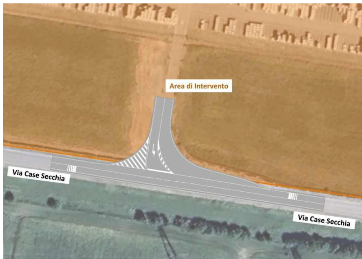
Figura 17 – Scenario di Intervento – Schema di progetto dell'accesso dei veicoli pesanti su via Case Secchia
